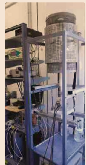
Particolare dell'impianto per misure elettrochimiche su celle a ossidi solidi (laboratorio di elettrochimica, DICCA, Università di Genova)
