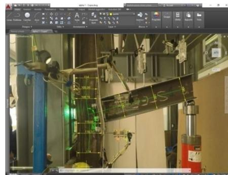
*Prove di carico di un giunto flangiato – analisi deformazioni.*
