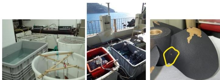
In figura, da sinistra a destra: il setup di laboratorio per prove in acqua di mare sintetica (NaCl); la stazione marina Ma.Re.Co. (Bonassola) per prove in acqua di mare naturale; un risultato di una prova di cavitazione su elica verniciata.
