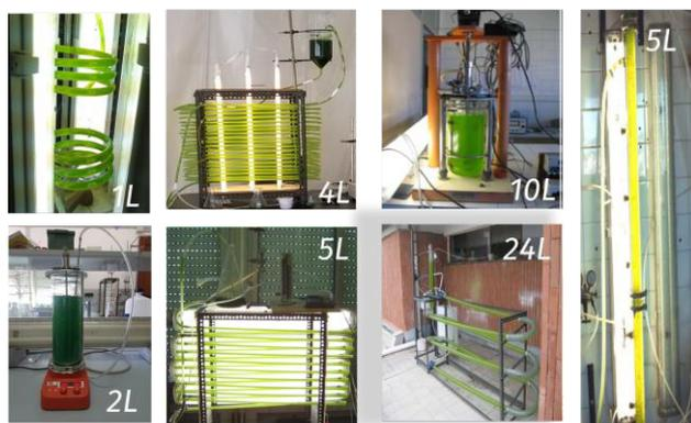
In figura sono illustrate alcune delle configurazioni di bioreattore usate. L'impianto tubolare orizzontale da 5 L ha consentito di ottenere una concentrazione di biomassa (circa 10 g/L peso secco) circa un ordine di grandezza superiore a quella di un comune open pond.
