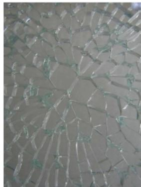
La figura illustra una inclusione di solfuro di nichel nel vetro. Il cambiamento di fase dell'inclusione, da a a b, produce l'aumento di volume che è all'origine della frattura spontanea del vetro (destra).
