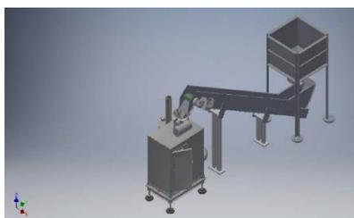
Fig.1 Prototipo progettato per ottenere le ceneri dalla paglia di riso.
